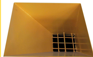
Trémie à concentrés minéraux et additifs sur capot mélangeur avec trappe à glissière
