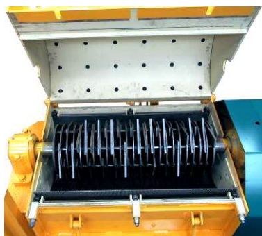
Vue du broyeur ouvert
