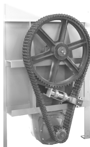
transmission par chaîne avec tendeur
