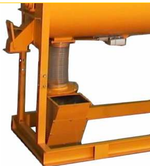
Boitard pour reprise par vis, sous le mélangeur et vérin électrique de commande de la trappe à glissière
