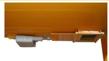
Elektrozylinder zur Steuerung des Gleitschieberventils
