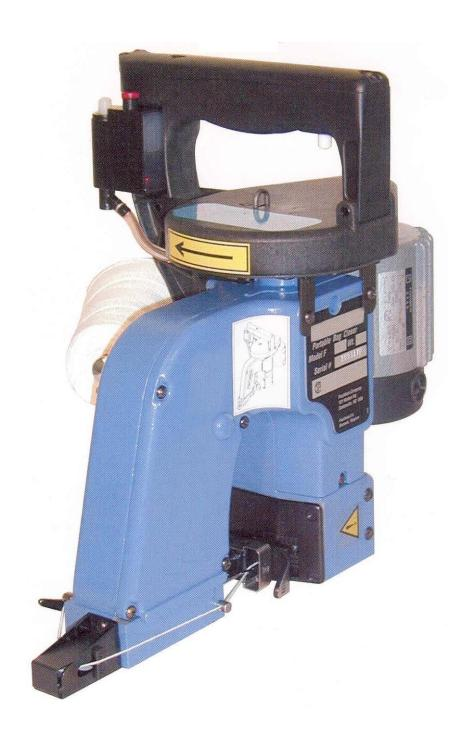
TRAGBARE NÄHMASCHINE ZUM VERSCHLIESSEN DER SÄCKE.
