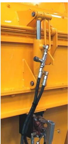
Hydraulik-System zur Öffnung der Mühle
