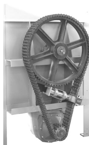
transmission par chaîne avec tendeur
