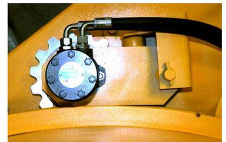
HYDRAULISCHER ANTRIEBSMOTOR DER TROMMEL
