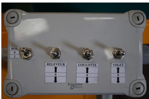
STEUEREINHEIT FÜR DEN ELEKTROHYDRAULISCHEN ANTRIEB DER TROMMELROTATION, DES HEBEFUSSES UND DER UMLENKKLAPPE
