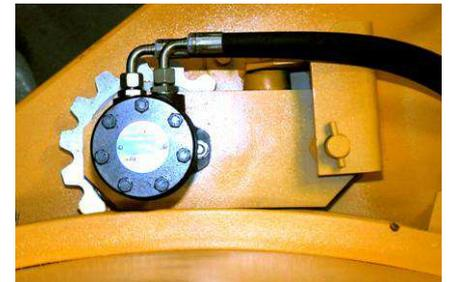
HYDRAULISCHER ANTRIEBSMOTOR DER TROMMEL
