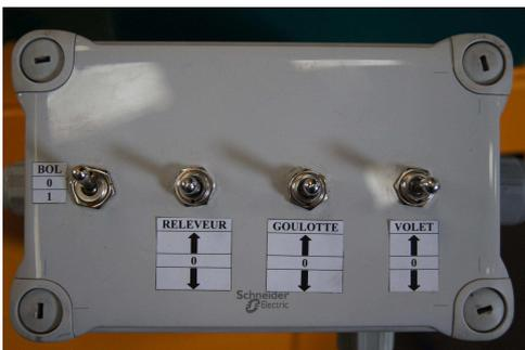
STEUEREINHEIT FÜR DEN ELEKTROHYDRAULISCHEN ANTRIEB DER TROMMELROTATION UND DES HEBEFUSSES
