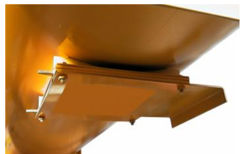
Gleitschieberventil unter dem Behälter
