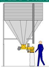
ensacheuse montée sur boisseau de stockage
