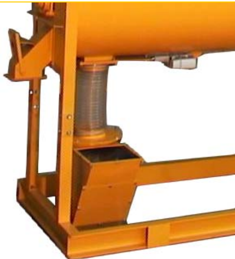
Eingang zum Herablassen der Förderschnecke
