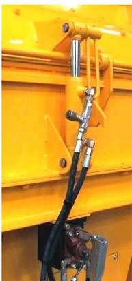
Hydraulik-System zur Öffnung der Mühle
