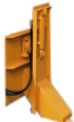
Hydraulikzylinder zur Fernsteuerung des Gleitschieberventils
