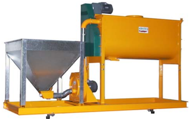
Futtermittelanlage auf Wiegerahmen montiert
